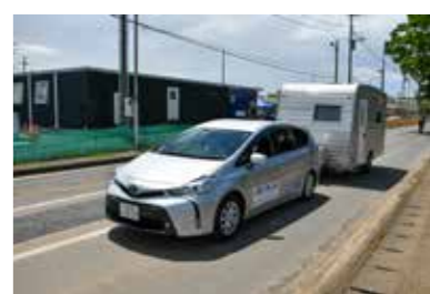
境町を出発した災害用トレーラ 普通自動車で牽引可能で気密性に優れ、空調冷暖房設備と100V/1500Wが使用可能な電源システムを2つ装備
