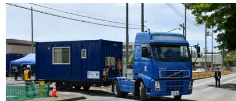
境町文化村を出発するコンテナハウス。今回、三鷹市に貸与したバス・トイレ・台所付きで、長さ6m（重さ2・5t）のホテル仕様サイズ
