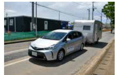
境町を出発した災害用トレーラ 普通自動車でも牽引可能で気密性に優れ、空調冷暖房設備と100V/1500Wが使用可能な電源システムを2つ装備
